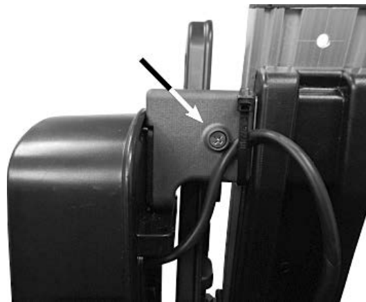
Figure 2 : Montage des feux arrière
