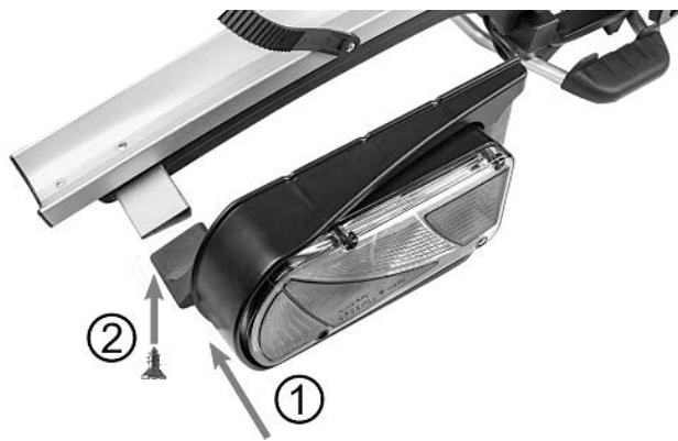
Figura 1: Montaggio luci posteriori
